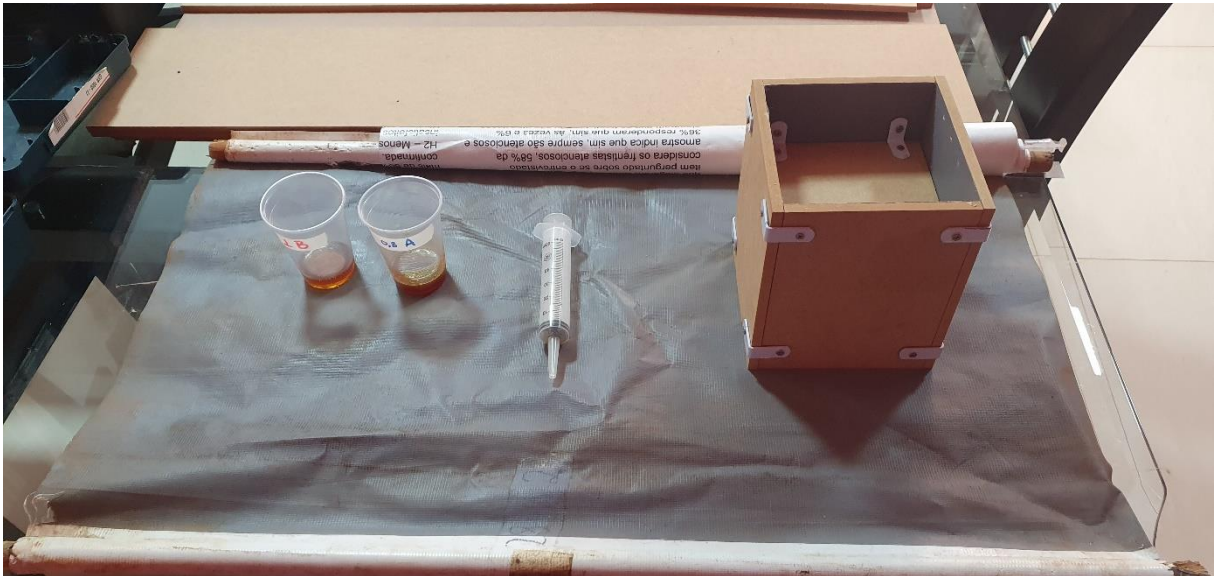
Imagem 32 – Preparação para aplicação do poliuretano nas placas.
