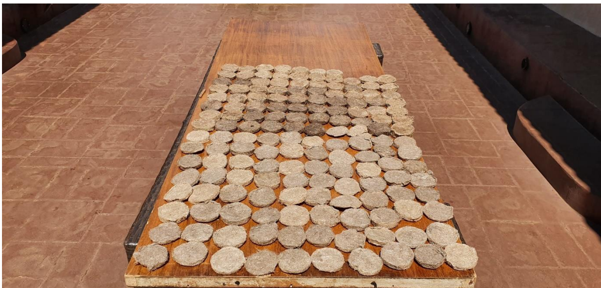
Imagem 24 – Fibras de bananeira prensadas secando ao sol.
