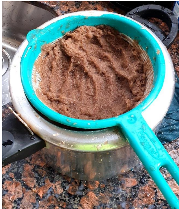
Imagem 21 – Retirada parcial da água das fibras de bananeira.
