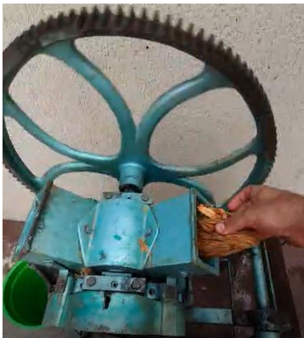
Imagem 12 – Pedacos do Coco passando pelo moedor Elétrico.
